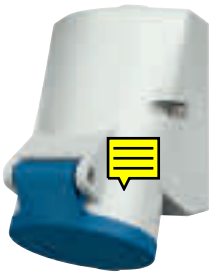
Wandcontactdoos schroefloos, met TwinCONTACT, geschikt voor doorlussen, binnenliggende bevestiging, behuizing 180° draaibaar bij 4- en 5-polige uitvoering
