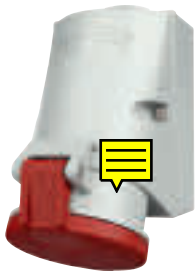
Wandcontactdoos schroefloos, met TwinCONTACT, geschikt voor doorlussen, binnenliggende bevestiging, behuizing 180° draaibaar, contactdozen zijn voorbereid voor de installatie van een hulpcontactschakelaar
